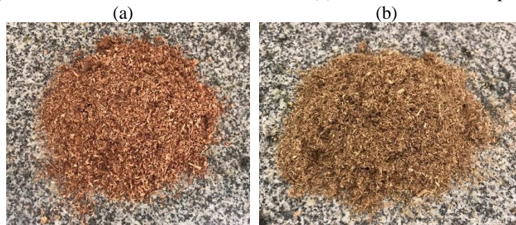
Figura 3- (a) Resíduo de madeira antes do tratamento (b) Resíduo de madeira após tratamento
