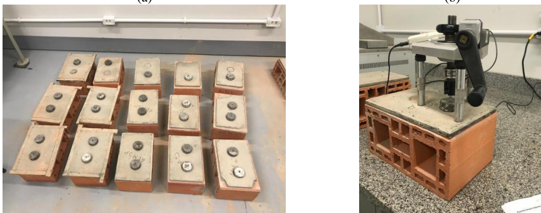
Figura 6 - (a) Substratos com pastilhas coladas, (b) Arrancamento com dinamômetro
